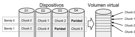
Figura 8.8: RAID 5 de 4 dispositivos (discos) con paridad Left Asymmetric .
