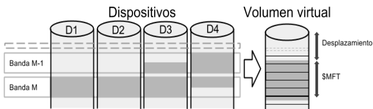
Figura 8.9: Ejemplo de distribución de la MFT en los dispositivos físicos y el virtual.
